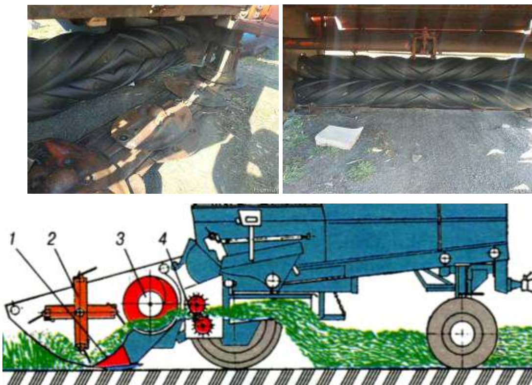
Рис. 2.5. Технологічний процес косарки зі встановленим механізмом плющення (позиція 4)
