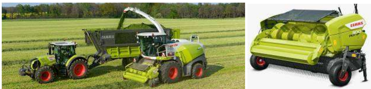
Рис. 2.18. Енергетичний засіб JAGUAR та підбирач PICK UP
