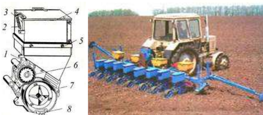
Рис. 2.5. Сівалка ССТ-12 та її посівна секція
