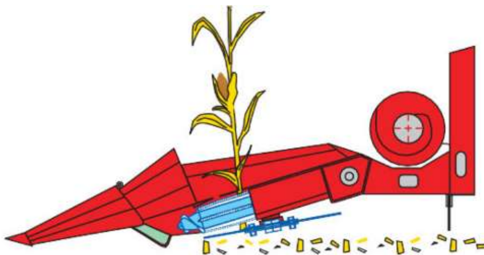
Рис. 2.7. Технологічна схема роботи жатки Dominoni S978B
