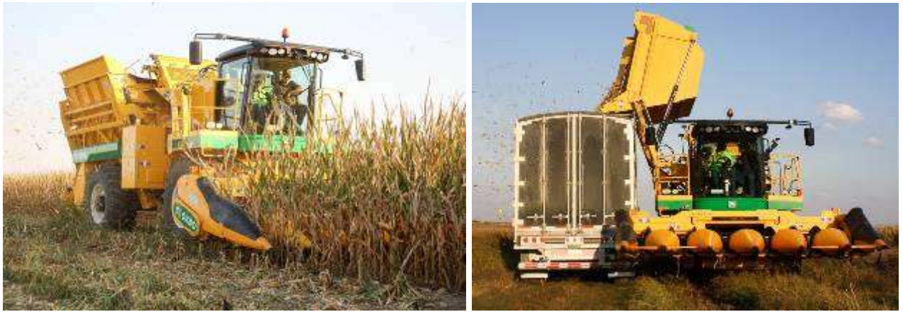
Рис. 2.4. Кукурудзозбиральний комбайн Охво 2460 (збирання кукурудзи в качанах)
