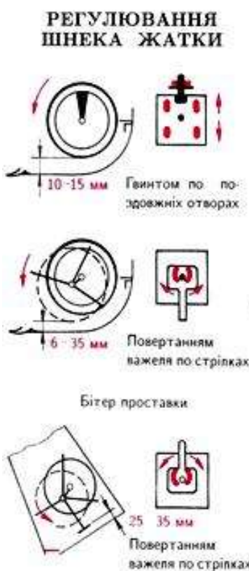
Рис. 2.12. Регулювання шнека жатки комбайна ДОН-1500Б [13]
