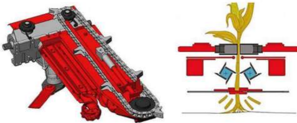
Фото 3. Загальний вигляд (а) та технологічна схема роботи (б) інтегрального апарата для відділення качанів та подрібнювального
