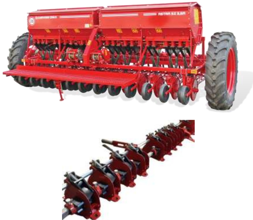
Рис. 2.11. Сівалки ASTRA 3,6 STANDART та її катушковий апарат
