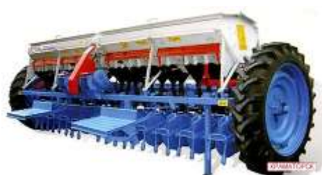
Рис. 3.2. Сільськогосподарська машина: зернотукова сівалка СЗ – 3,6.
