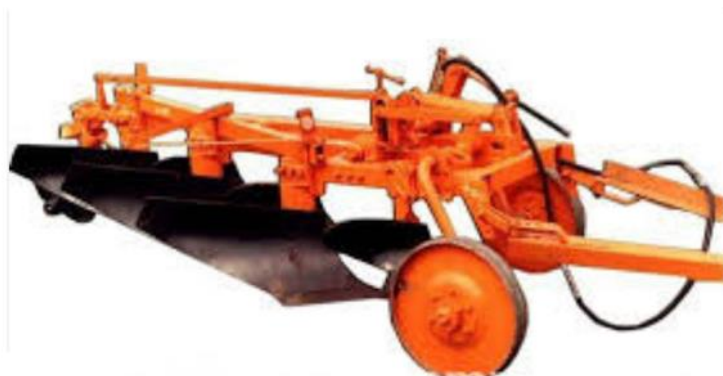
Рисунок 2.5 Плуг причіпний двоярусний ПЯ-3-35
