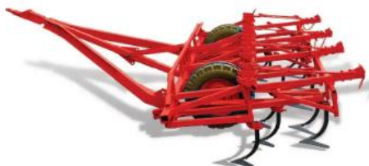
Рисунок 2.8 Культиватор причіпний КПС-4
