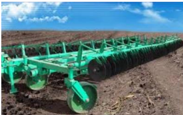
Рисунок 2.1 Луцильник дисковий ЛДГ-10
