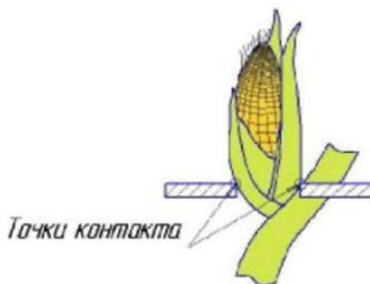
Рисунок 2.9 – Точки контакту качана з робочими органами
