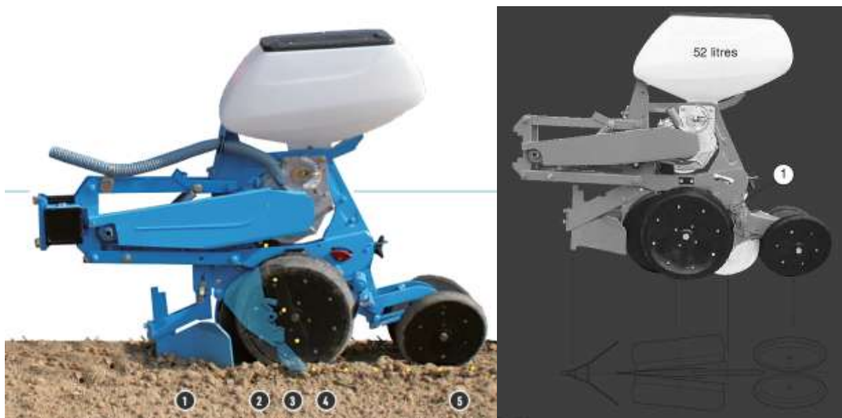
Рис. 2.12. Висівна секція сівалки [9]
