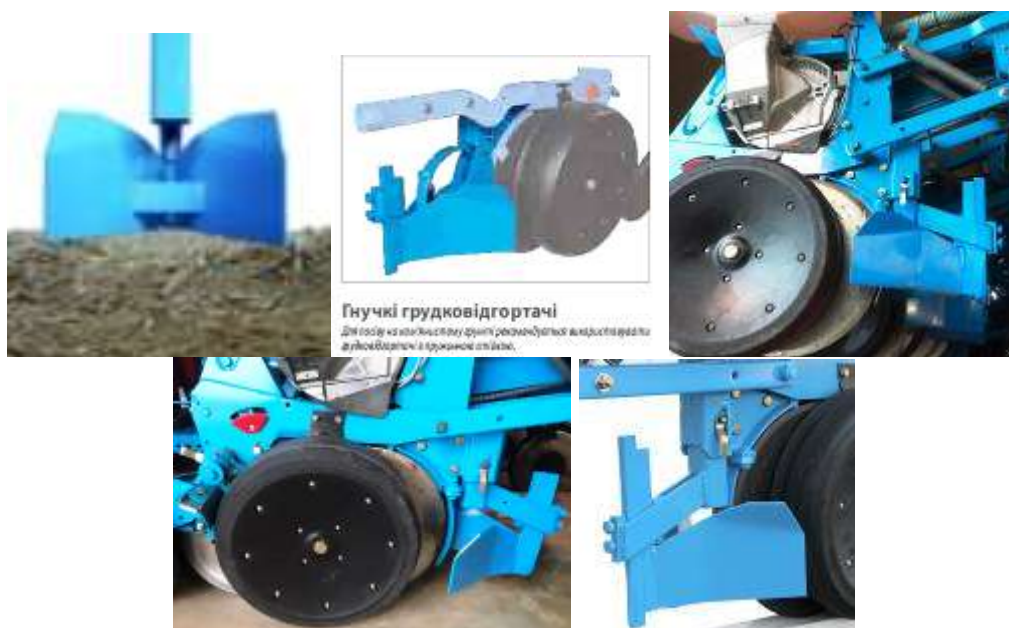
Рис. 2.13. Відгортач посівної секції [9]
