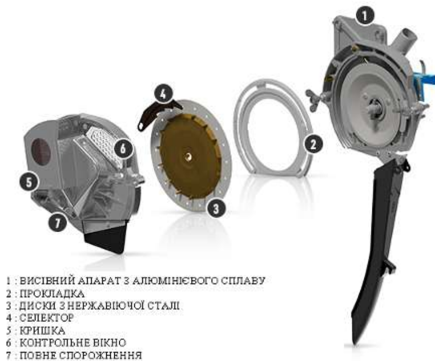
Рис. 2.19. Посівний механізм французької сівалки Monosem з дисковим висівним апаратом NG Plus 4 [9]
