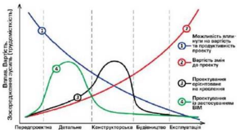
Рисунок 2.8 Зміна ціни та можливостей внесення змін у проект із часом від початку проектних робіт при звичайному проектуванні та із застосуванням BIM [45].
