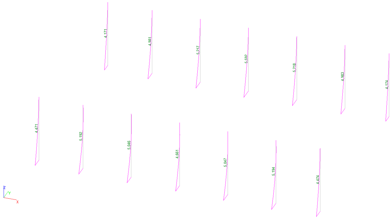
Рисунок 2.3.18. Схема колон каркасу до реконструкції із зазначенням величин зусиль згинального моменту M_y відносно осі Y ( m \times m )
