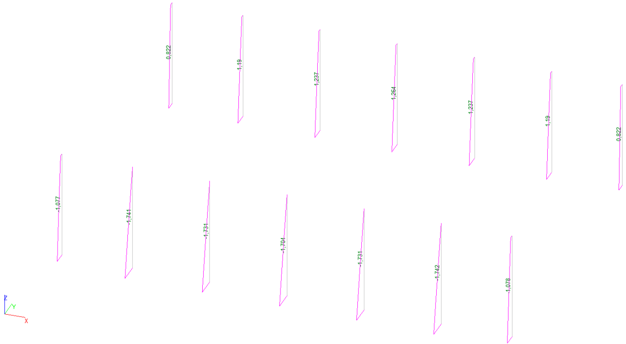
Рисунок 2.3.22. Схема колон каркасу після реконструкції із зазначенням величин зусиль поперечної сили Q_z відносно осі Z (m)
