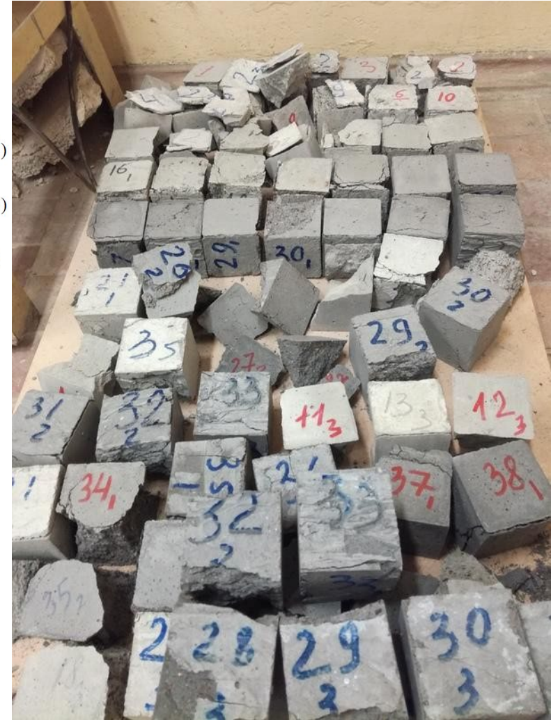
Зразки бетону після випробування на міцність
