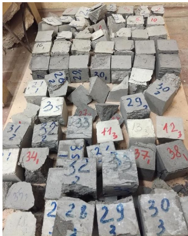
Рис. 3.9 Зразки бетону після випробування на міцність
