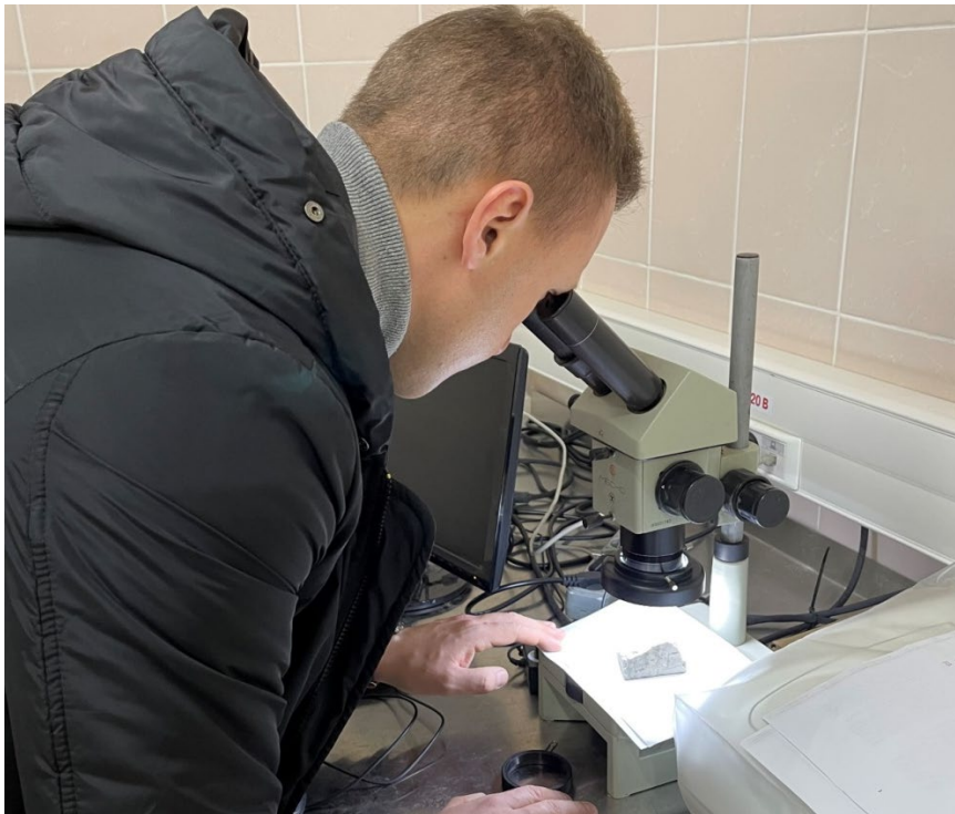
Рис. 3.10 Дослідження складу мілкозернистого бетону за допомогою растрового мікроскопу зі збільшенням від 20 до 1500 раз
