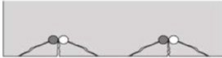
Рис. 3.12 Руйнування бетону у зв'язку з малою відстанню до кромки
