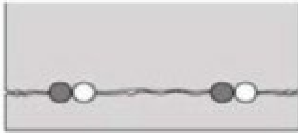
Рис. 3.13 Руйнування бетону у зв'язку з малою осьюовою відстанню
