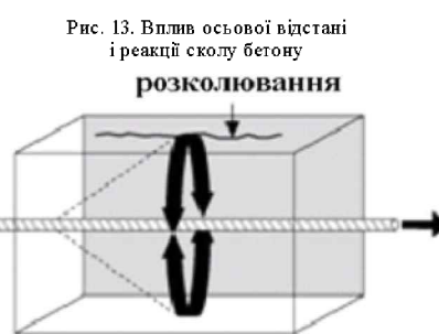
Рис. 11. Розколювання бетону в зв'язку з малою відстанню до кромки
