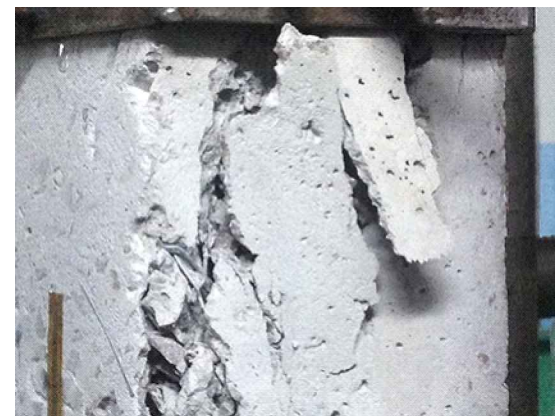
Характер руйнування дослідного зразка із фрезерованою сталеві фіброю після випробувань на міцність на стиск
