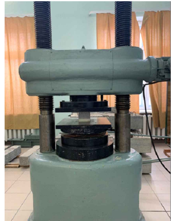
Випробування зразків сталеві фібробетону на стиск
