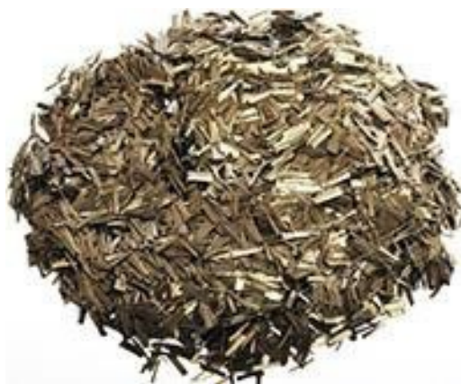
Рис. 3.9. Зовнішній вигляд фібри, виготовленої з порід базальту
