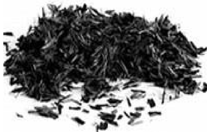
Рис. 3.8. Зовнішній вигляд фібри з вуглецю
