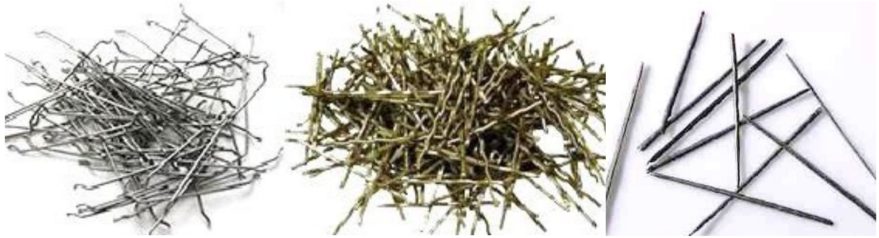
a - анкерна; б - хвилеподібна; в - у вигляді прямих відрізків
