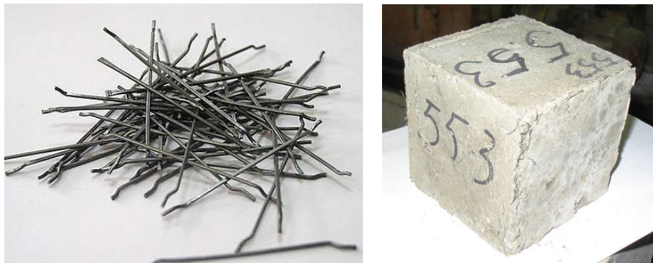
1 – дротові волокна для дисперсного армування зразків; 2 – готовий СФБ куб
