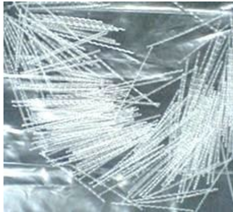
Рис. 3.7. Зовнішній вигляд фібри з полімерних волокон
