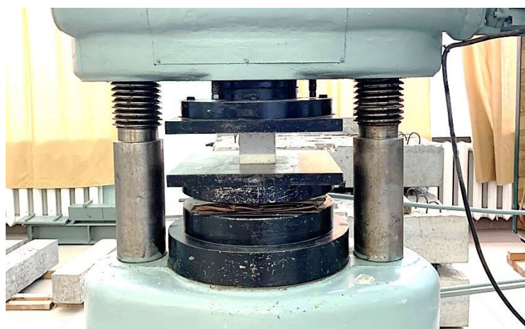
Рис. 3.11. Випробування зразків зі сталевий фібробетону на стиск
