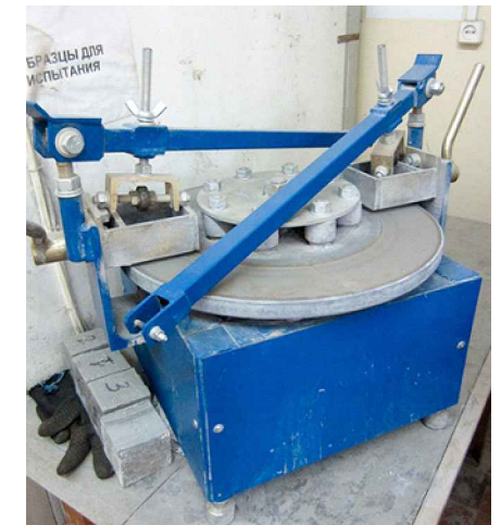
Лабораторне коло для визначення стирания з дослідними зразками
