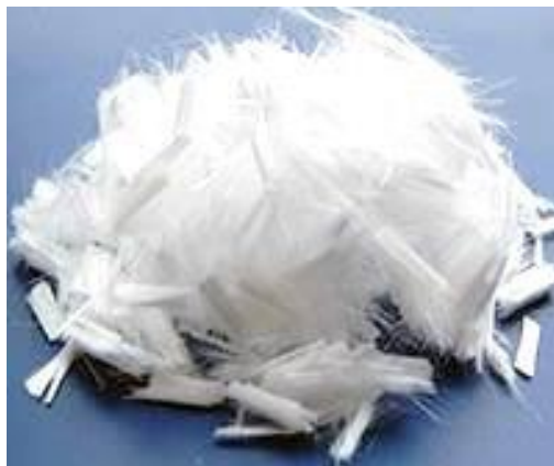
Рис. 1.6. Форма і текстура фібри, виготовленої з поліпропілену
