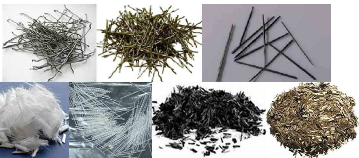
Види фібри для дисперсного армування конструкцій: а - стальна анкерна; б - стальна хвилеподібна; в - у вигляді прямих відрізків; в - з поліпропілену; г - з полімерних волокон; д - з вуглецю; е - з базальту
