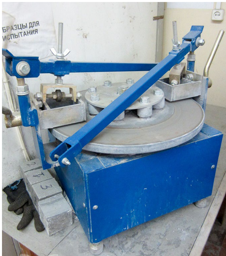
Рис. 8.4. Лабораторне коло для визначення стиранисті ЛКІ-3
