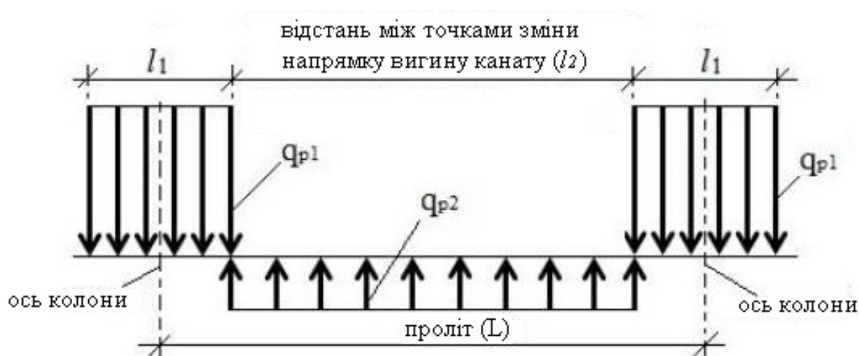
Рис. 8.18 Додаткові навантаження в конструкціях від вертикальних складових зусилля натягу
