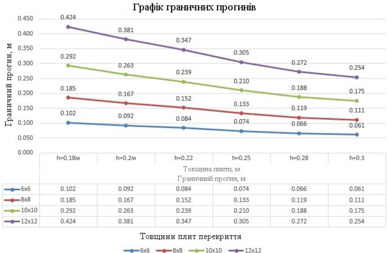
Рис. 3.15. Графіки граничних прогинів для різних чарунків в стадії руйнування
