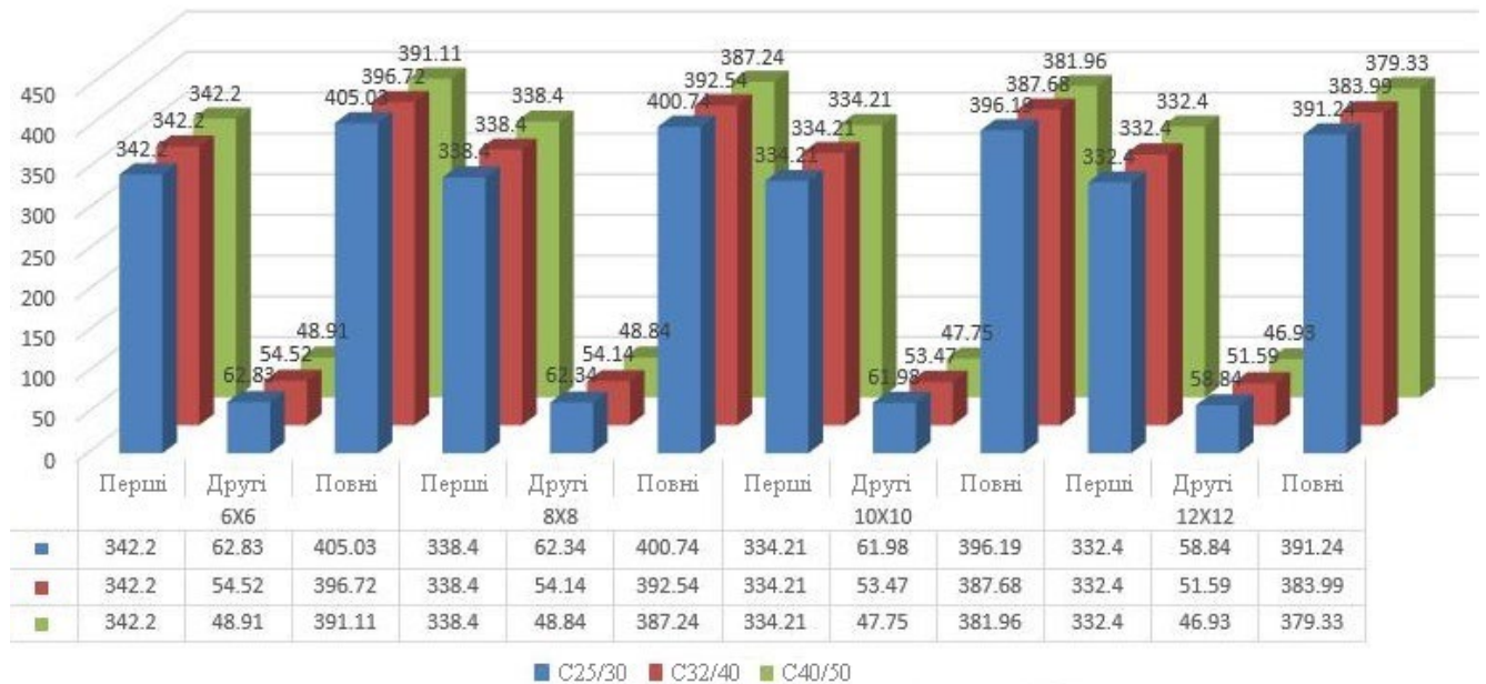
Рис. 3.10 Залежність втрат попереднього напруження від розмірів чарунків
