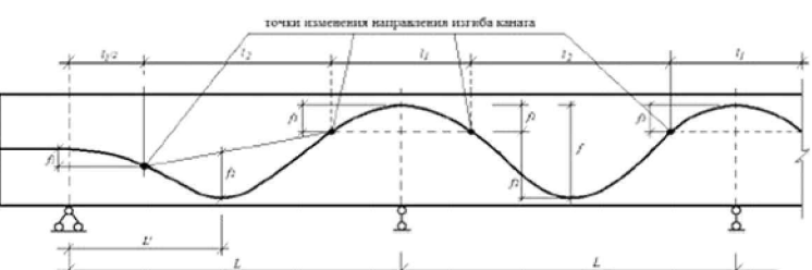
Геометрія розкладки арматурних елементів по висоті перерізу конструкції по траєкторіях прогонових і опорних парабол
