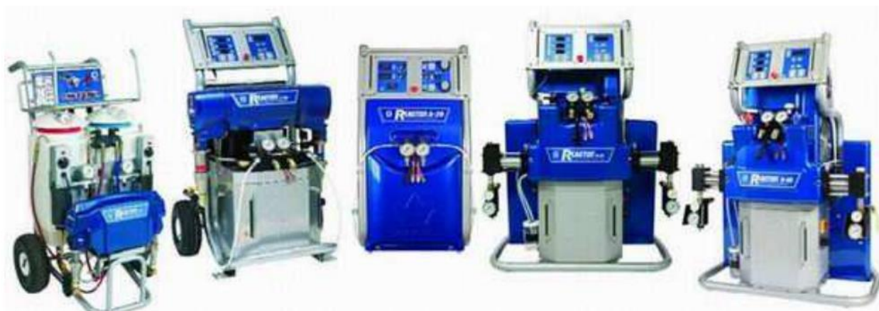
Рисунок №22 Засоби та механізми для влаштування напилюємої гідроізоляції з полісечовини
