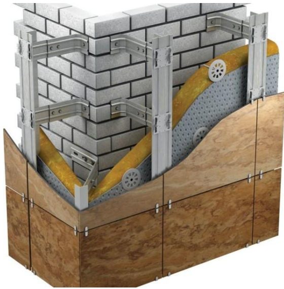
Рис. 1 Навісний фасад у розрізі.
