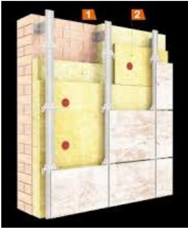
Рис. 7 Подвійне утеплення стіни під вент фасадом.
