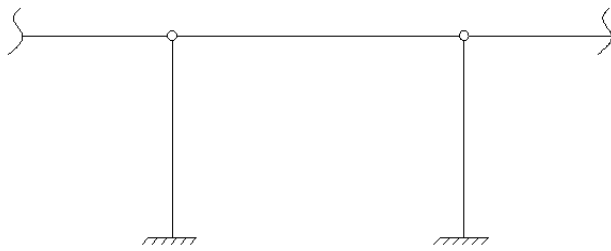
Рис. 2.2. Шарнірне кріплення ригелів до колони.
