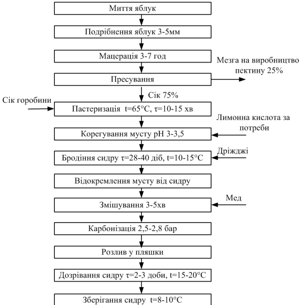
Рис.8. Технологічна схема виготовлення сидру із горобиновим соком
