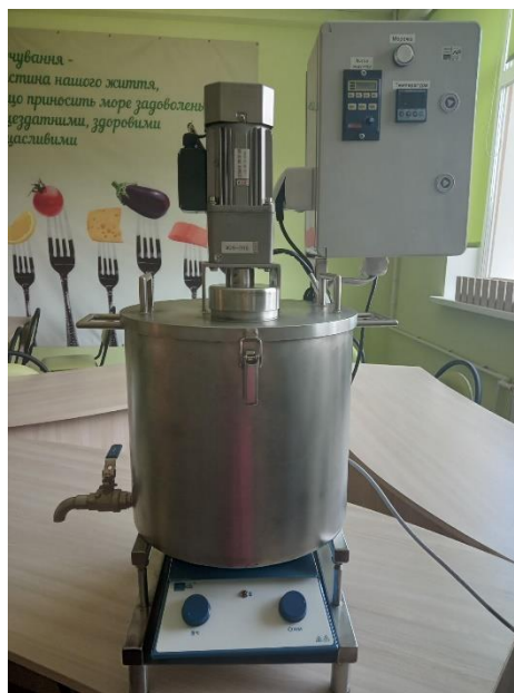
Рис.3. Лабораторна установка для проведення осмотичної дегідратації
