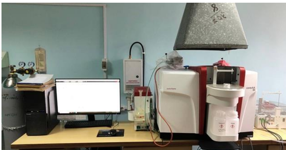
Рис. 3.9 Атомно-абсорбційний спектрометр «contrAA 800 D»
