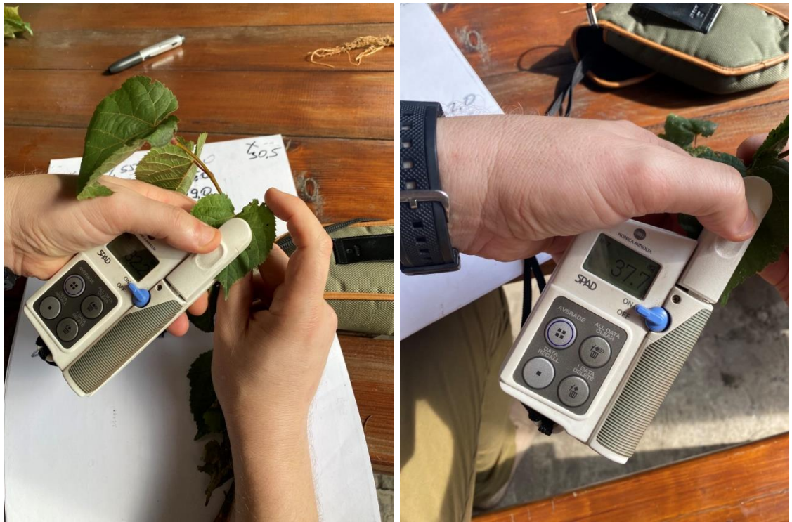
Рис. 3.2.2. Визначення вмісту хлорофілу приладом SPAD-502 plus в листках дворічних сіянців липи дрібноквіткової на базі лабораторії кафедри садово-паркового та лісового господарства (Сумський НАУ, вересень, 2023 р).
