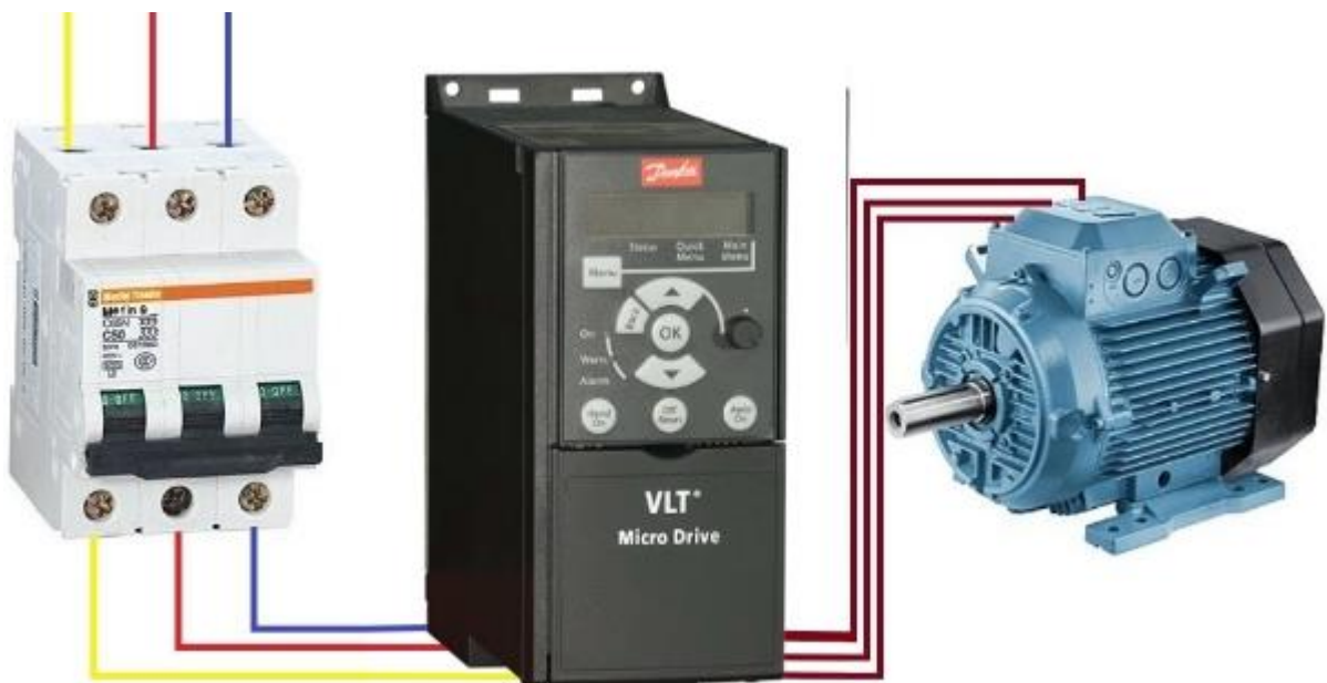
Рисунок 2.1. Модель керування частотою обертання двигуна змінною частотою електричного струму
