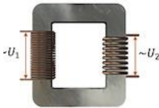
Рисунок 3.4. Принцип дії понижуючого трансформатора
