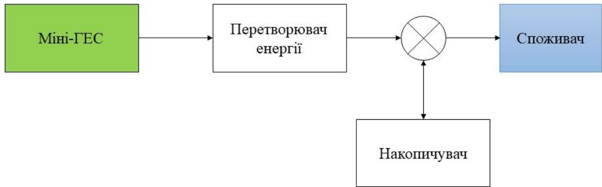
Рисунок 3.5 – Схема узгодження з виконанням накопичування електроенергії
