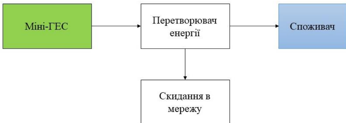
Рисунок 3.4 – Схема узгодження на основі передавання надлишкової електроенергії до загальної мережі
