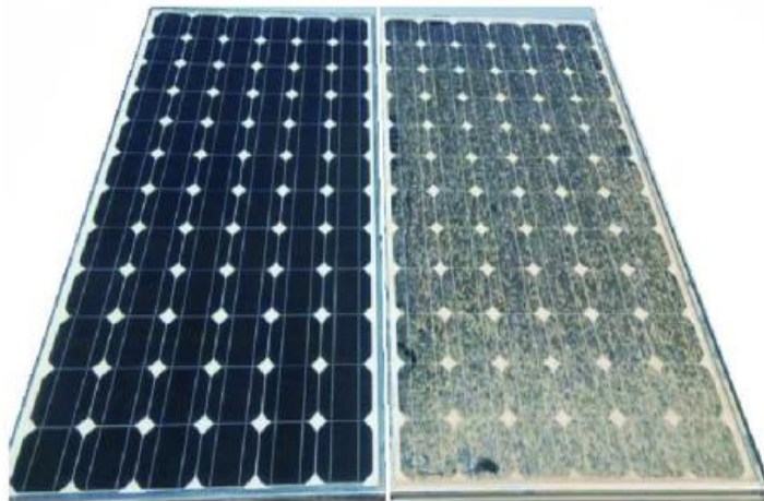
Рисунок 1.3 – Особливості запилення сонячних палей в порівнянні з чистою
