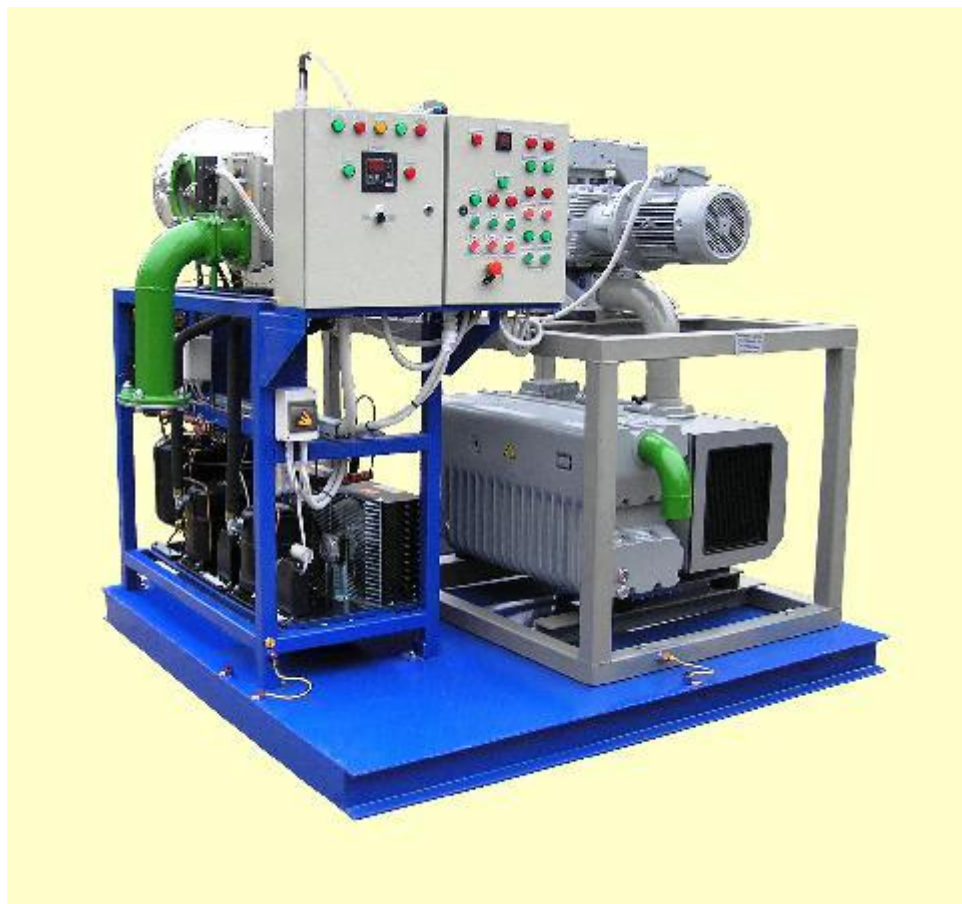
Рисунок 3.1 – Установка для обробки твердої ізоляції силових трансформаторів «ЕТМА Іній 7-550-1×150 (-70) У1»
