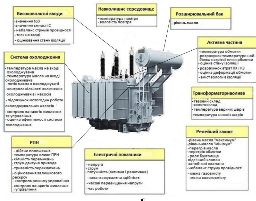
Рисунок 3.2 – Діагностуючі прилади силового трансформатора
