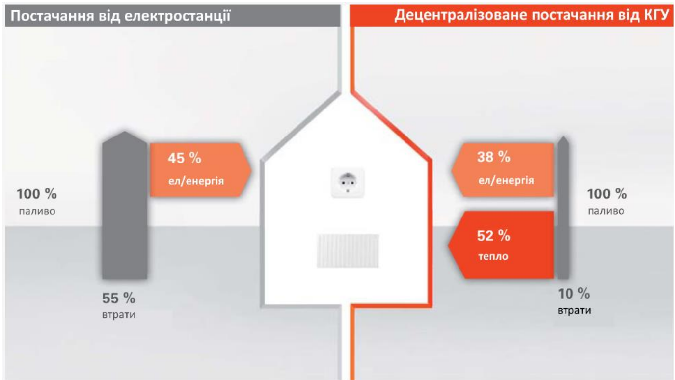
Рисунок 1.1. Роль когенераційної установки в цілісній енергетичній системі
