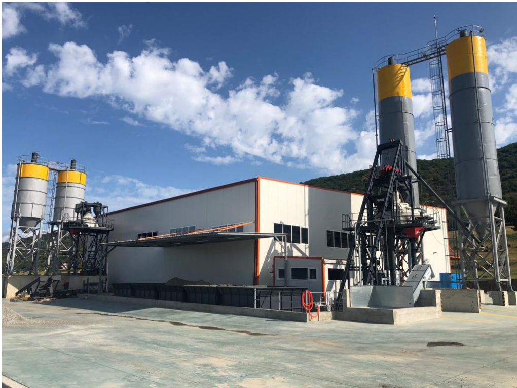
Рисунок 1.2 – Бетонозмішувальна установка (БЗУ-60)
