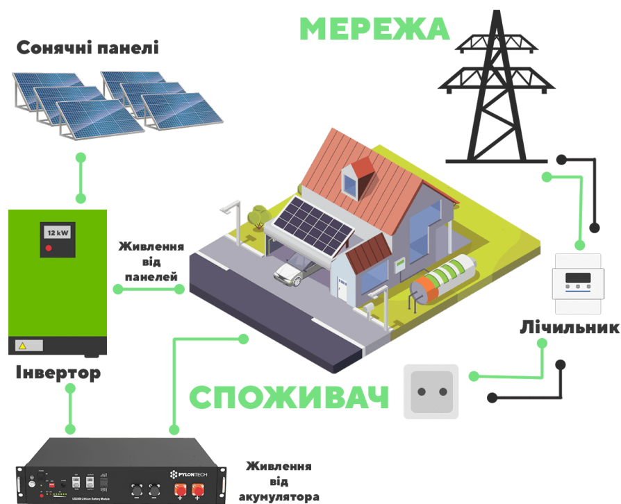
Рис. 1.2. Схема роботи гібридної сонячної електростанції
