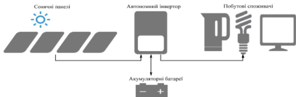
Рисунок 1.6 – Загальна схема сонячної електростанції автономного типу
