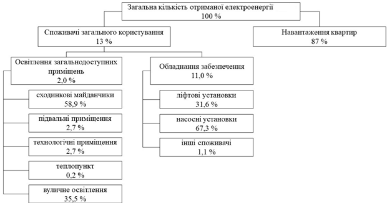
Рисунок 1.6 – Розподіл електроенергії в багатоквартирному будинку
