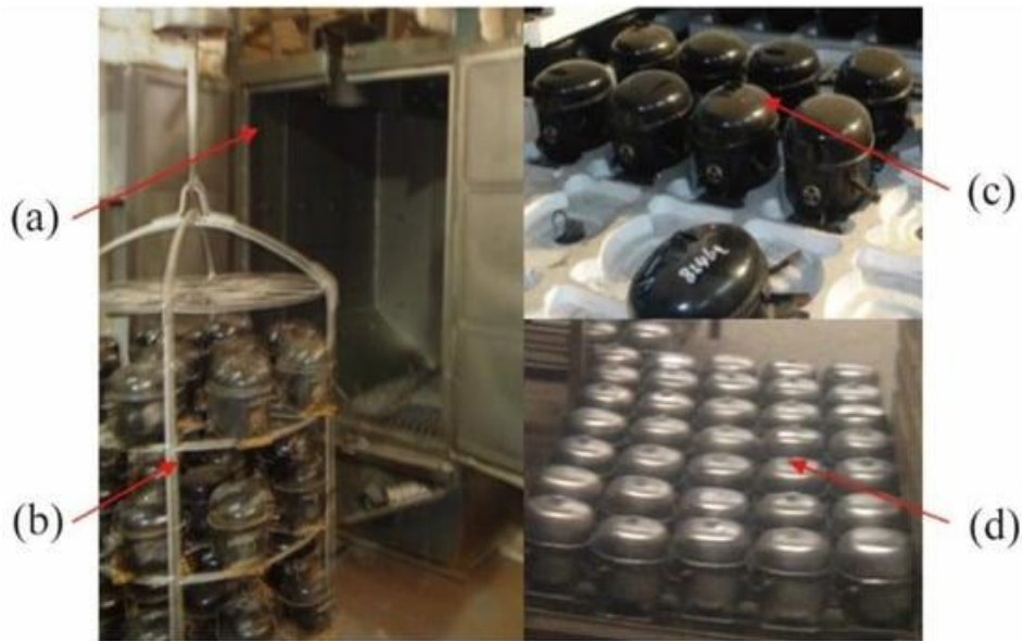
Рисунок 1.6 - Дробеструйна обробка поверхні компресора: (а) дробеструйна машина, (б) підвіс, (с) до струминної обробки та (д) після струминної обробки
