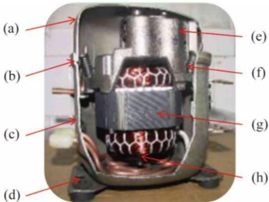
Рисунок 1.4 - Конструкція продуктів холодильного компресора: (a) верхня оболонка, (b) зварний шов, (c) нижня оболонка, (d) підставка, (e) картер, (f) гакова пружина, (g) статор двигуна та (h) колінчастий вал
