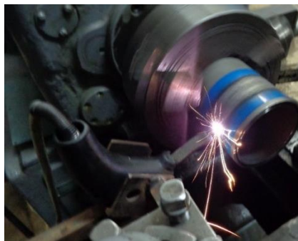
Рисунок 2.1 - Процес відновлення поверхні валу в автоматизованому режимі
