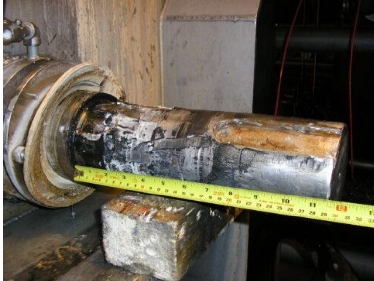
Рисунок 1.6 - Зношена посадкова зона підшипника валу
