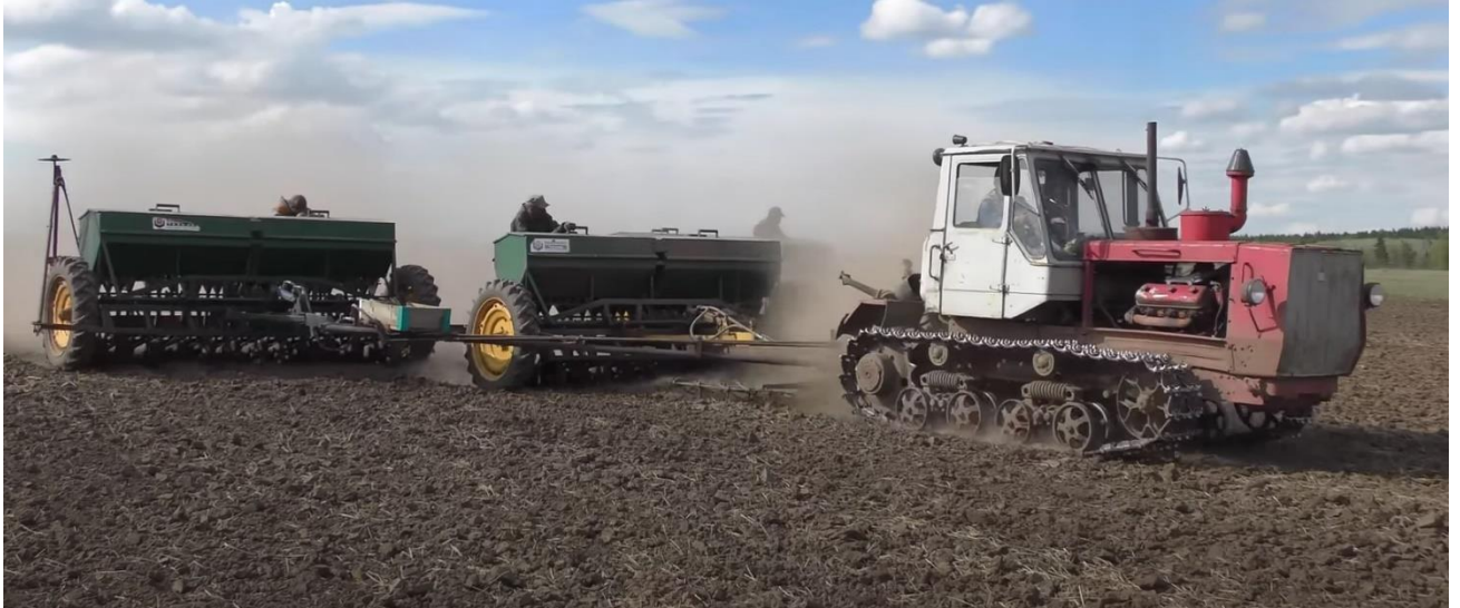
Рисунок 3.5 - Гусеничний трактор Т-150 із трьома модернізованими сівалками СЗ-3,6 (вид спереду)
