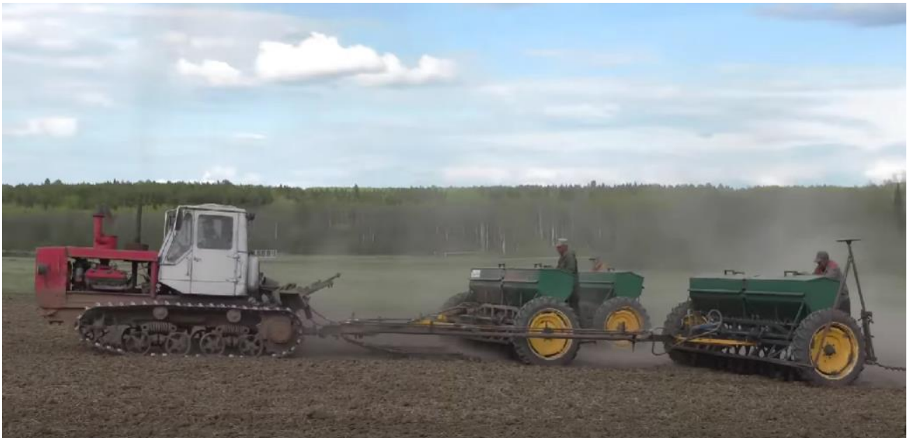
Рисунок 3.6 - Гусеничний трактор Т-150 із трьома модернізованими сівалками СЗ-3,6 (вид збоку)
