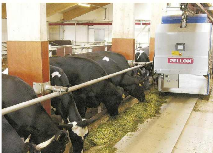
Рисунок 1.4 – Роботизована система годівлі тварин з роздавачем з обмеженою мобільності
