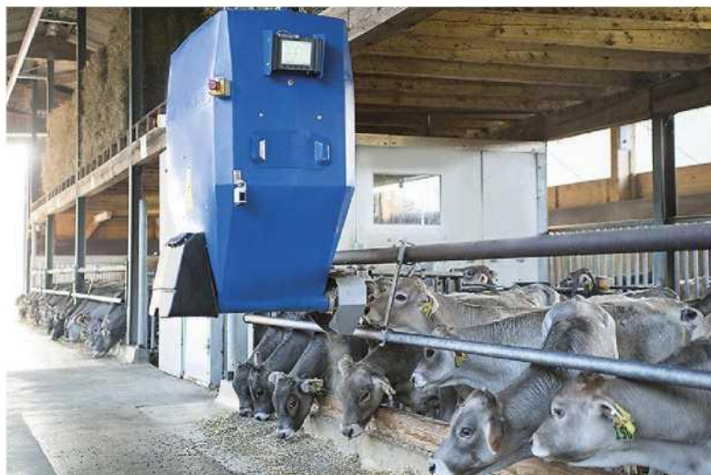
Рисунок 1.6 – Підвісний монорельсовий роздавач концентрованих кормів фірми «Westfalia»
