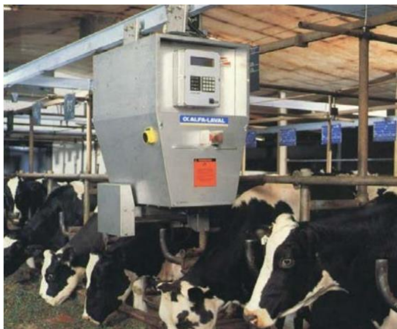
Рисунок 1.7 – Монорельсовий роздавальник комбікормів «DeLaval»
