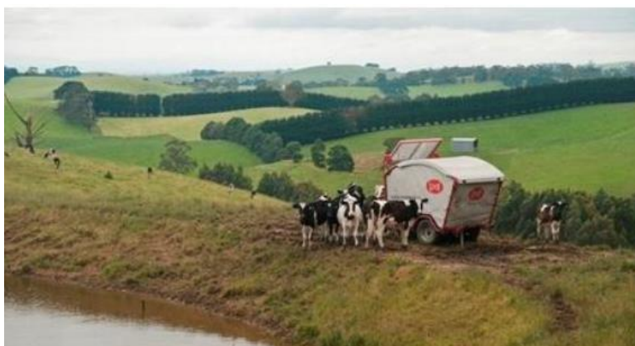
Рисунок 1.17 – Мобільна станція роздачі концентрованих кормів LelyCosmix M
