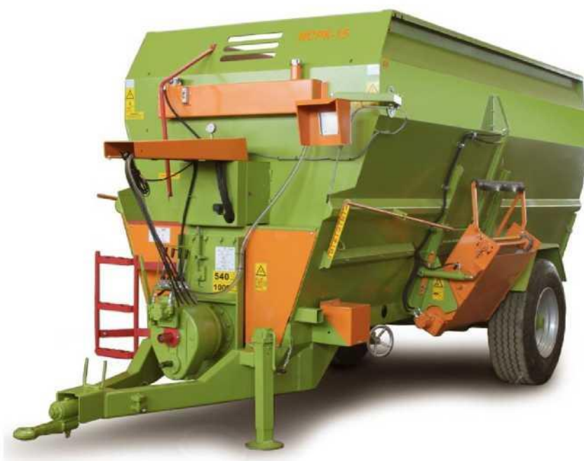
Рисунок 1.2 – Подрібнювач-змішувач-роздавач кормів ІСРК-12
