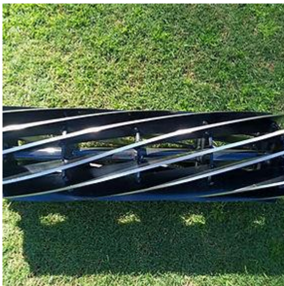
Рисунок 1.3 – Каток з планками спіралевидного типу
