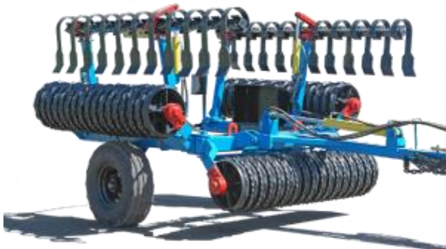
Рисунок 1.4 - Каток рублячий КПП-6 «Отман»
