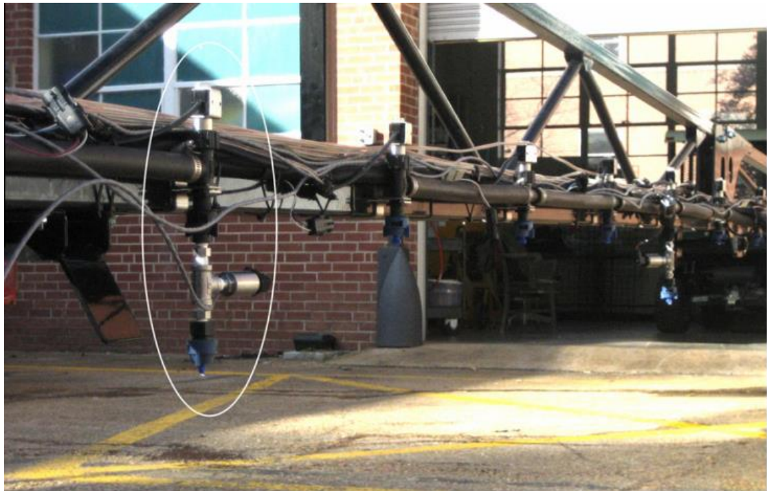
Рис. 2 - Ілюстрація соленоїдів і датчиків тиску, встановлених на патрубках уздовж секцій штанги
