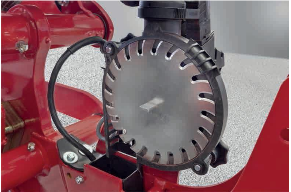
Рисунок 3.12. Налаштування дозатора насіння HORSCH Maestro під посів кукурудзи
