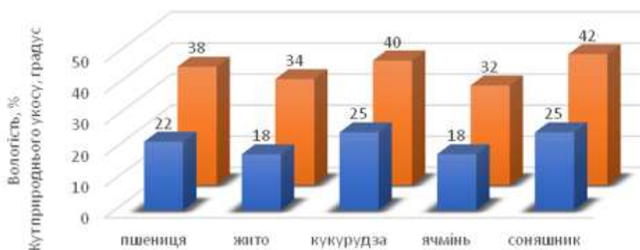
Рис. 3.6. Значення кута природного укосу за максимальної вологості (вологість – синій колір).
