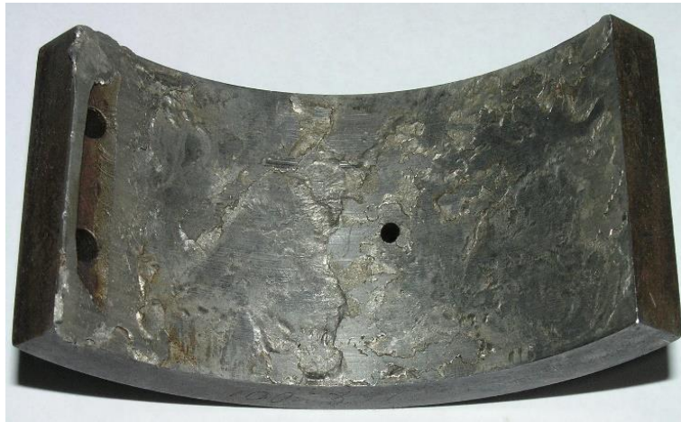
Рисунок 2.2 - Руйнування бабітового шару покриття під дією абразивних часток
