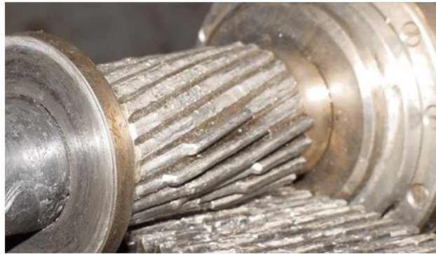
Рисунок 1.10 - Пошкоджений ВК через стрибок [2]
