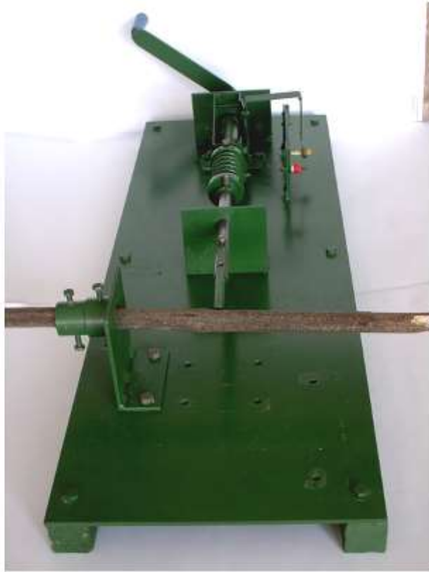
Рис. 3.9. Пристрій для визначення характеристик сільськогосподарських матеріалів на згин
