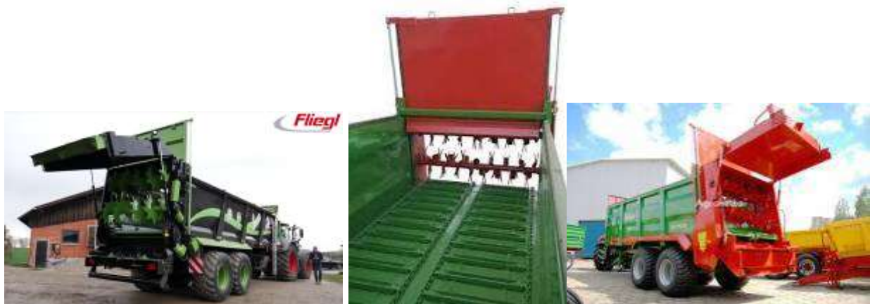
Рис. 2.5. Розкидачі органічних добрив з дисковим розкидальним робочим органом
