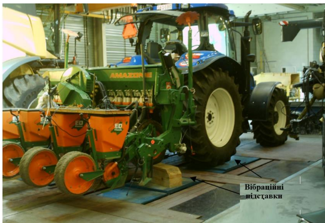
Рис. 4 – Вібраційні стійки з чотирма плакатами для струшування машини, що імітує польові умови; задні колеса трактора та два колеса аплікатора були розміщені на струшувальних підставках і вимірювався час затримки падіння добрива
