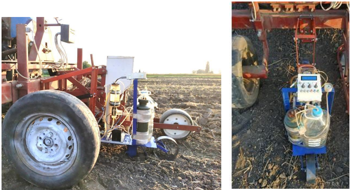
Рисунок 3.2 - Гідравлічна сівалка, розроблена для експериментів, має мехатронну систему контролю та регулювання
