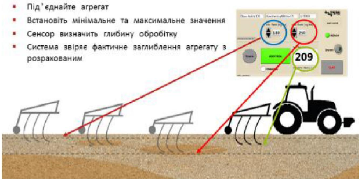
Рисунок 3.13 - Схема налаштування агрегату на диференційований обробіток ґрунту
