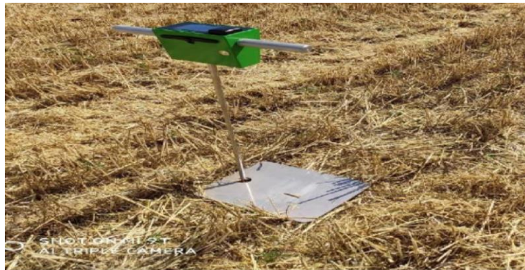
Рисунок 2.10 - Загальний вигляд цифрового пенетрометра S600, оснащеного GPS GSM антенами
