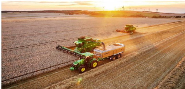
Рисунок 2.5 - Приклад використання системи AMS зі стандартом ISOBUS при вивантаженні зерна з синхронізацією швидкості агрегатів
