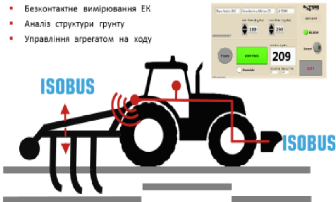
Рисунок 3.9 - Схема диференційованого обробітку ґрунту технологією TopSoil Mapper
