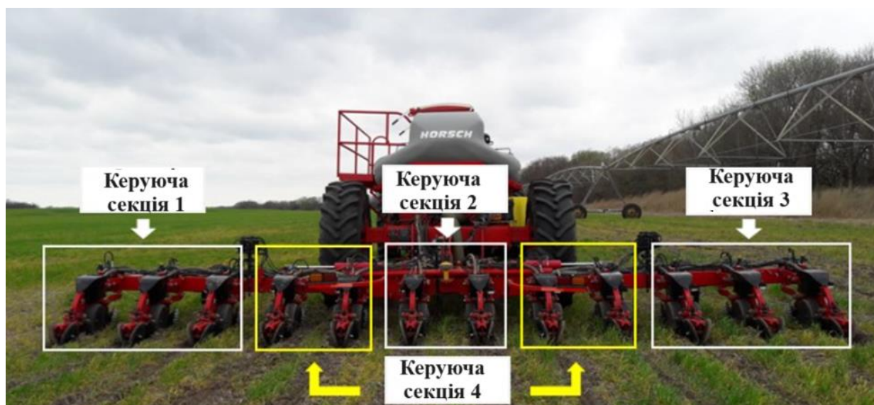
Рис. 8 - Панель інструментів посівної машини розділена на 4 різні секції керування
