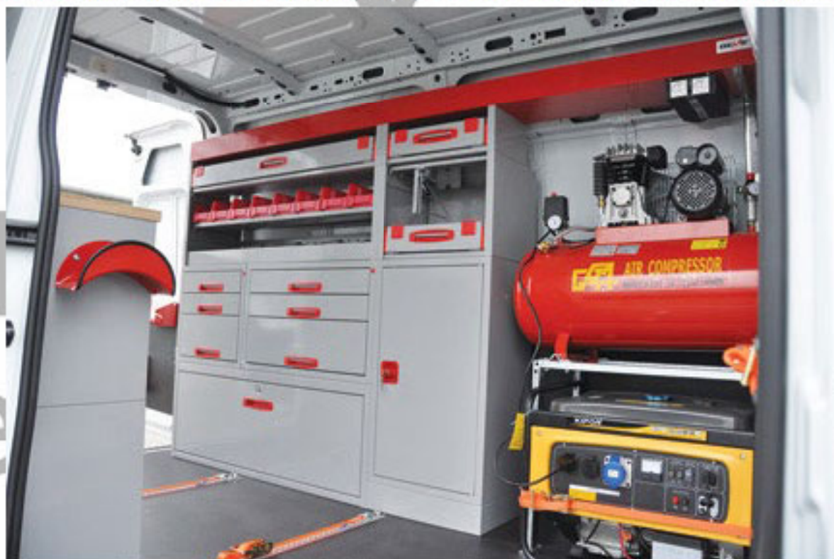
Рисунок 2.8 – Варіант комплектування мобільного пункту ТО і ремонту комбайнів John Deere
