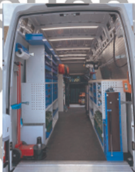
Рисунок 2.7 – Варіант комплектування мобільного пункту ТО і ремонту комбайнів John Deere
