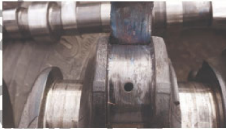
Рисунок 1.4 – Пошкодження шійки шатуна через відсутність мастила
