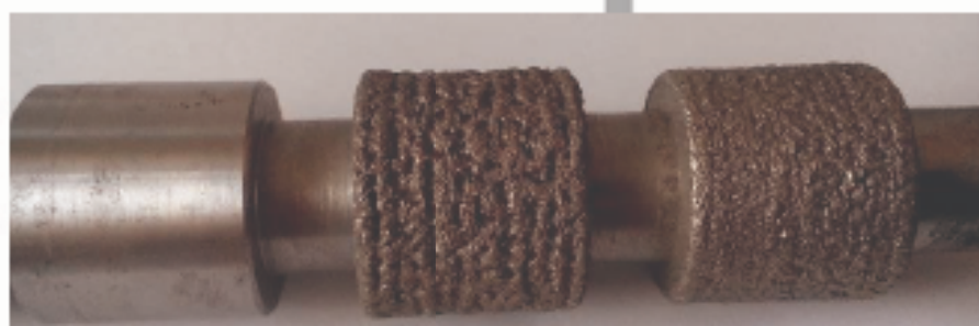
Рисунок 2.5 – Покриття на ділянках зразка зі сталі 40Х (а – без покриття) електродами зі сталей 08Х15Н5Д2Т(б) 12Х18Н10Т (в) та нанесеними на механізованій установці моделі «УІЛ-9».
