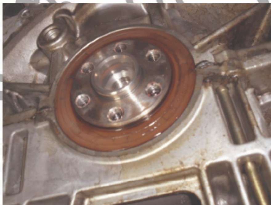
Рисунок 1.4 – Ушкодження сальника колінвалу, який необхідно замінити
