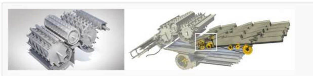
Рис. 1.7. Система обмолоту комбайна New Holland серії модельного ряду CX8 (два барабана та регульоване підбарабання Opti-Tresh (сайт https://technotorg.com/ )
