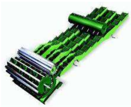
Рис. 1.10. Комбайн John Deere 9640 (9660, 9680) WTS та система обмолоту
