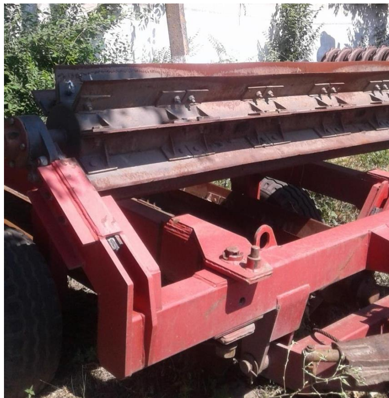
Рисунок 1.9 – Дослідний зразок барабана з ексцентриковим валом
