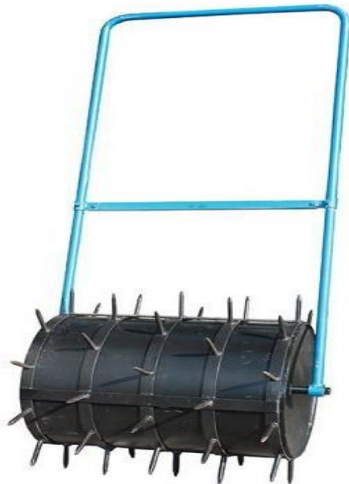
Рисунок 1.10 – Саморобний каток-подрібнювач для садово-паркових господарств
