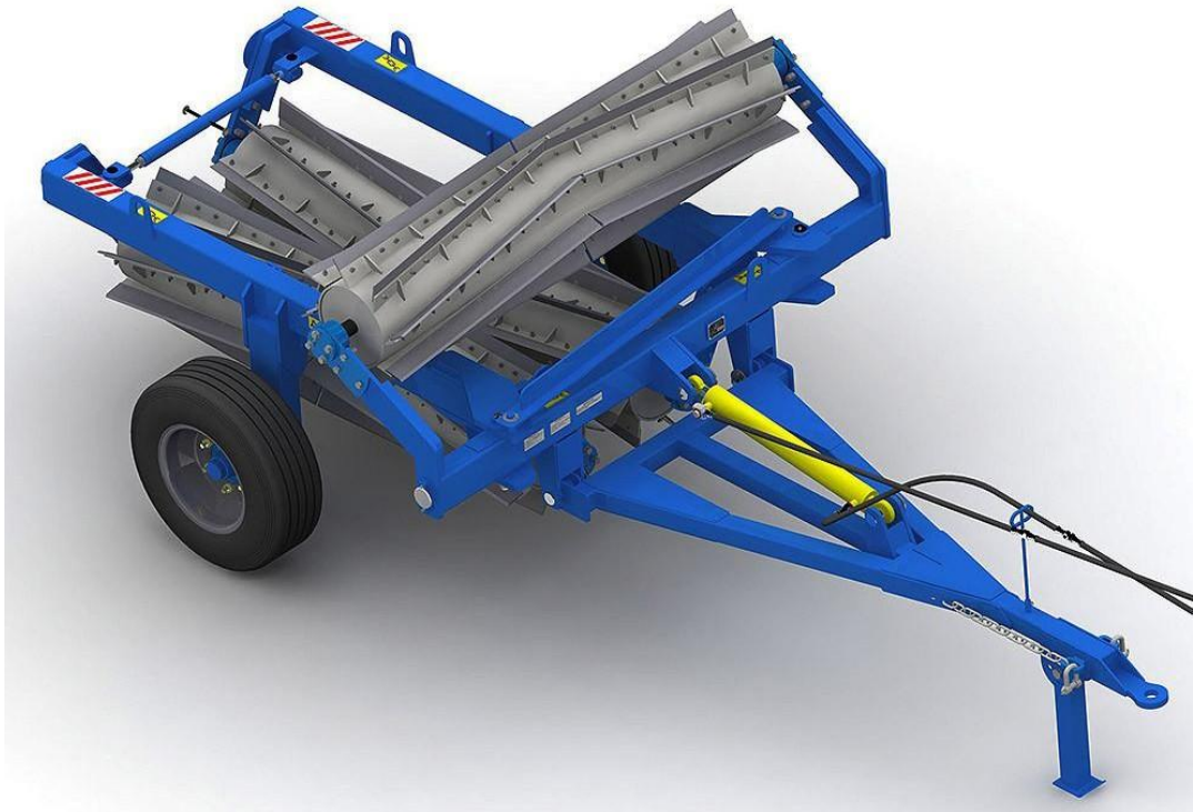
Рисунок 1.3 – Барабан катка, оснащений ножами шевронного профілю
