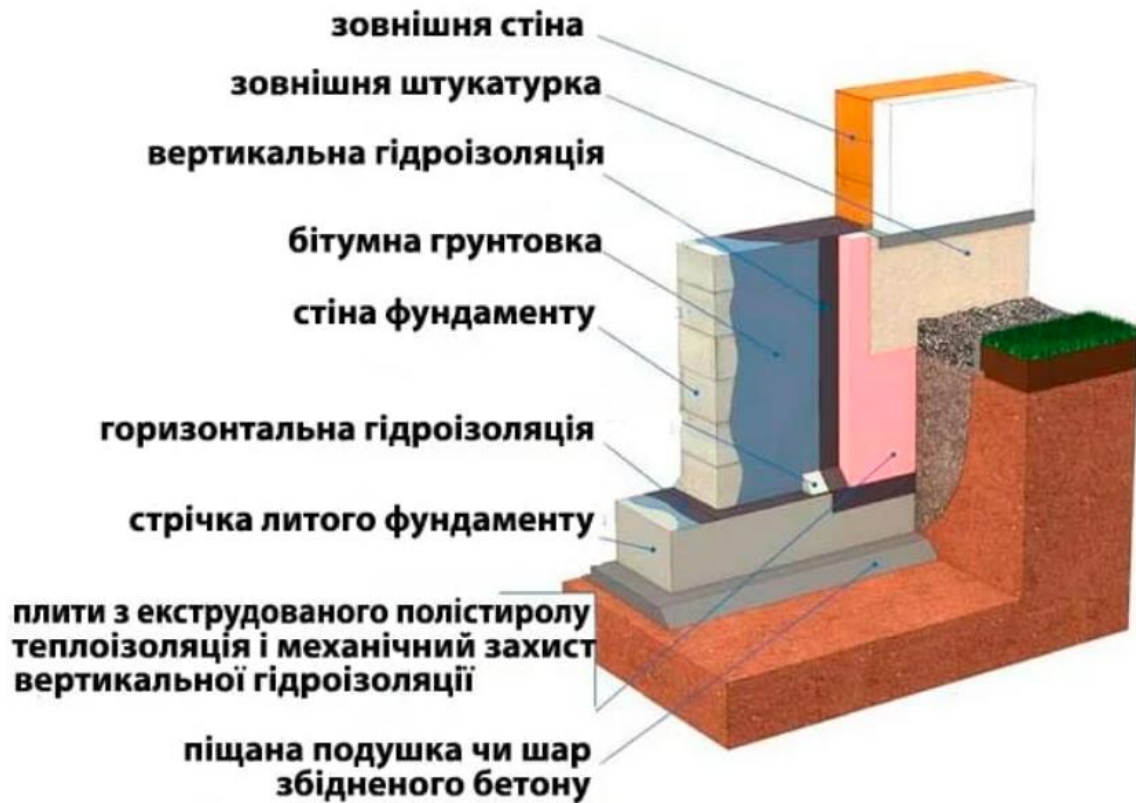
Рис. 9. Приклад комплексного утеплення фундаменту
